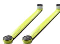
• L'**optojump** : appareil également utilisé en préparation physique, il permet d'évaluer les **qualités musculaires** des membres inférieurs.
